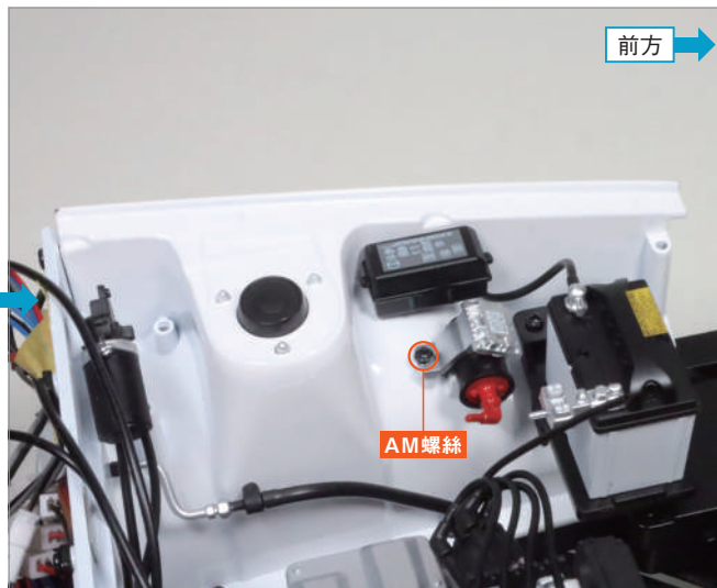
將 46-G 的突起部分嵌入 40-A 的凹槽中，並使用 AM 螺絲 固定。
